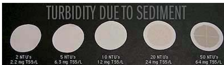
Abb.4 : Vergleich von Filtraten von Wasserproben unterschiedlicher Trübe (NTU) mit der Konzentration suspendierter Partikel (TSS: Total Suspended Solids in mg/l)
