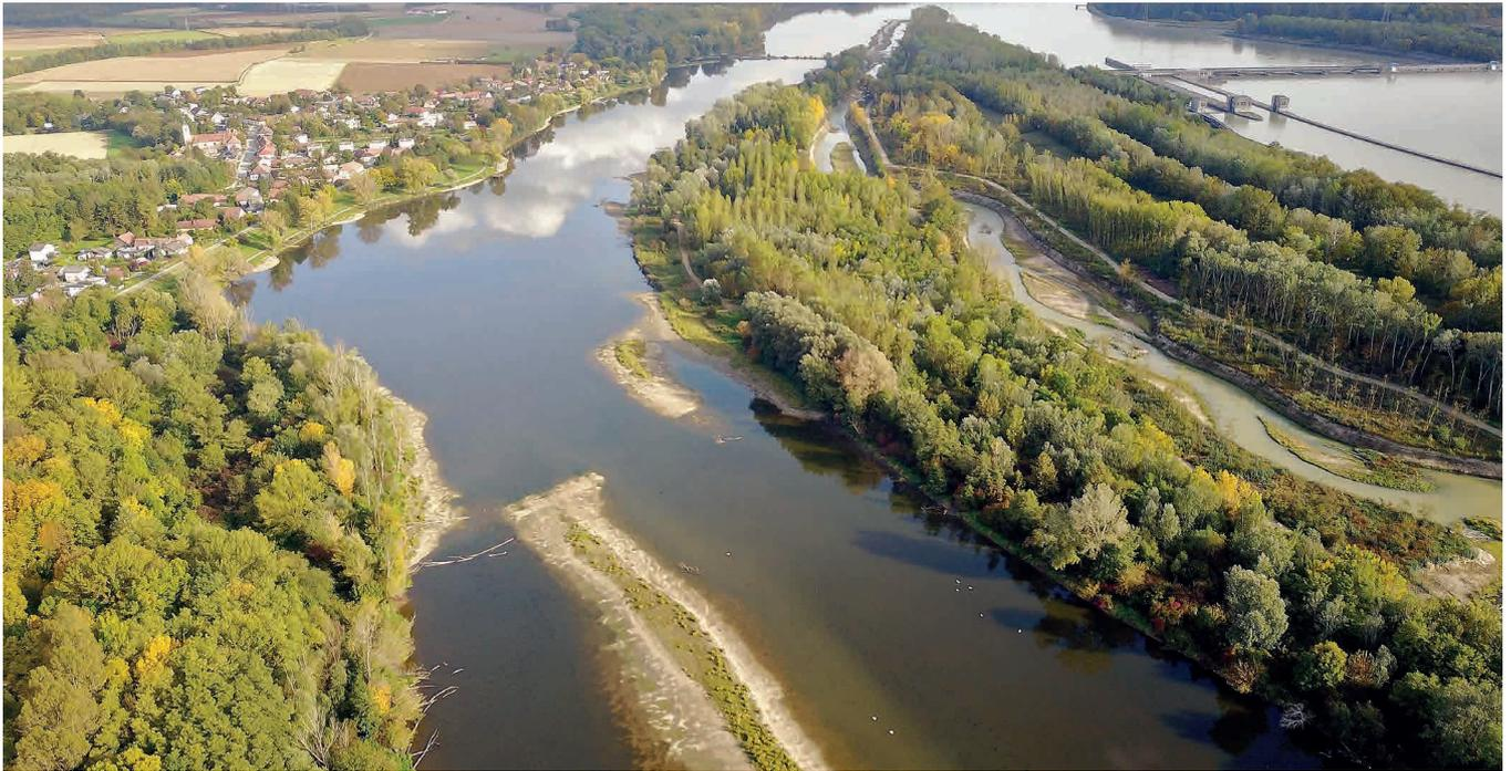
Abbildung 1: Altenwörther Altarm Blickrichtung flussab mit neuen wechselfeuchten Flachuferzonen in Form von Inseln und Uferschüttungen.
